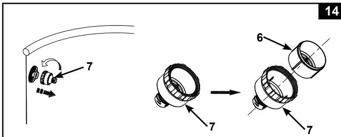
4. Vuelva a montar todos los componentes siguiendo los pasos anteriores a la inversa.
