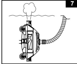
8. Encienda la bomba de filtrado y compruebe que el agua fluye a través de la micropantalla (6) y el adaptador de manguera (7). El limpiador automático deberá empezar a moverse y aspirar el suelo. Ver Fig. 8.
