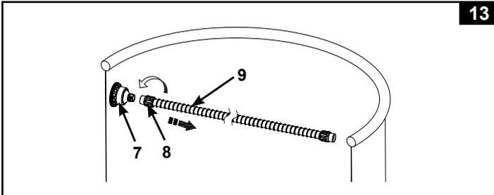
3. Desenrosque (en sentido antihorario) el adaptador de la manguera (7) del conector roscado de colador. Retire la micropantalla (6) del adaptador de la manguera. Use una manguera de jardín para limpiar y enjuagar cualquier residuo que pudiera haber en la micropantalla y en el adaptador de la manguera. Ver Fig. 14.
