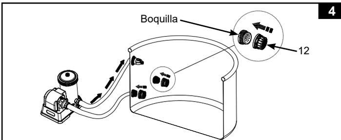
**Nota:** Retire el accesorio de extensión de la rejilla del colador (12) de la salida de succión de la rejilla del colador cuando el limpiador automático no esté en uso o cuando esté desconectado de la piscina.
