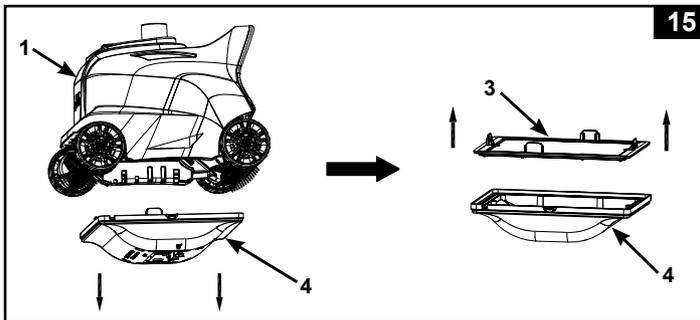
6. Vuelva a montar la malla de residuos del limpiador automático y la base siguiendo los pasos anteriores a la inversa.
