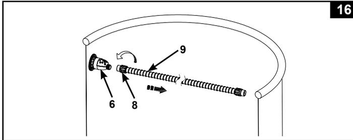
3. Desenrosque la válvula de liberación de presión (6) del conector de filtro roscado. Retire la micropantalla (5) de la válvula de liberación de presión. Use una manguera de jardín para lavar y desalojar los restos de suciedad de la micropantalla y de la válvula de presión. Ver Fig. 17.
