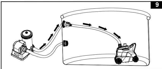
10. Encienda la bomba de filtrado y compruebe que el agua fluye por la micropantalla (5) y la válvula de liberación de presión (6). El limpiador automático estará ahora desplazándose y aspirando el suelo y paredes de la piscina. Ver Fig. 10.
